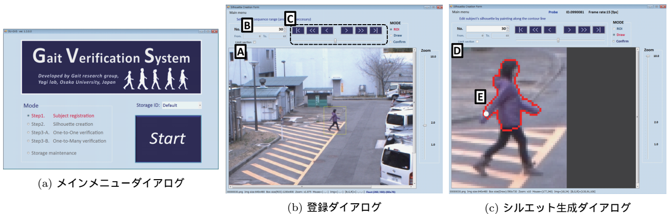
図 4 メインメニュー、登録モジュール、シルエット生成モジュールのインターフェースダイアログ。(A) 入力画像列、(B) 表示されている画像のフレーム番号、(C) 画像列閲覧制御パネル、(D) 対象の切り抜き画像、(E) 対象のシルエットの輪郭線(赤線)。
